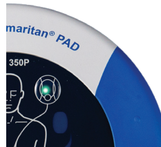
Figur 10. Blinkende grøn LED. Ingen handling påkrævet.
